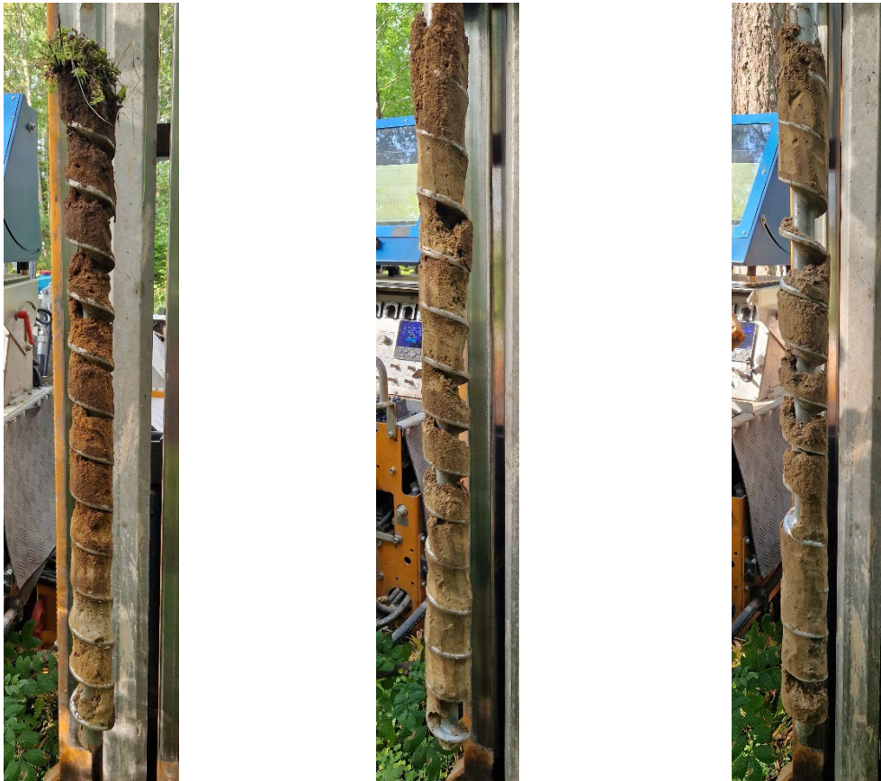
Figur 4. Jordprovtagning i punk 2304 med skruvborr på bandvagn med markprofilen 0-1m djup (t.v.), 1-2 m djup (m) respektive 2-3 m djup (t.h.).
