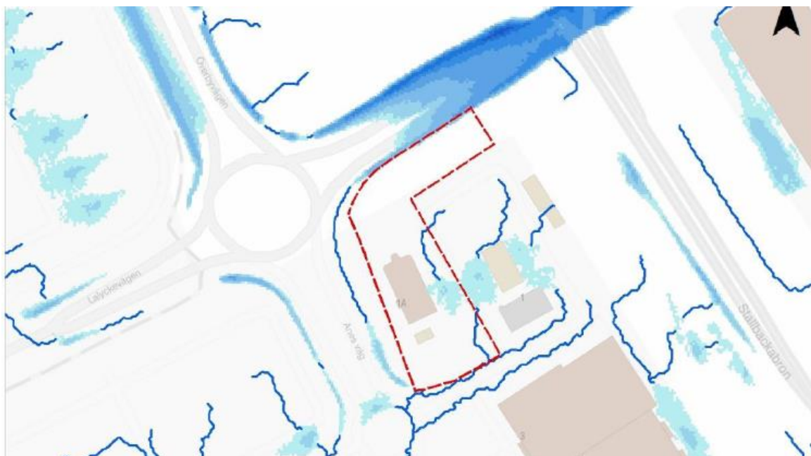
Bild 12. Flödesvägar och lågpunkter inom utredningsområdet vid ett 100-årsregn, vid nuvarande höjdsättning (Scalgo 2022). Planområdet visas med röd streckad linje. Från WSP dagvattenutredning, 2022.
