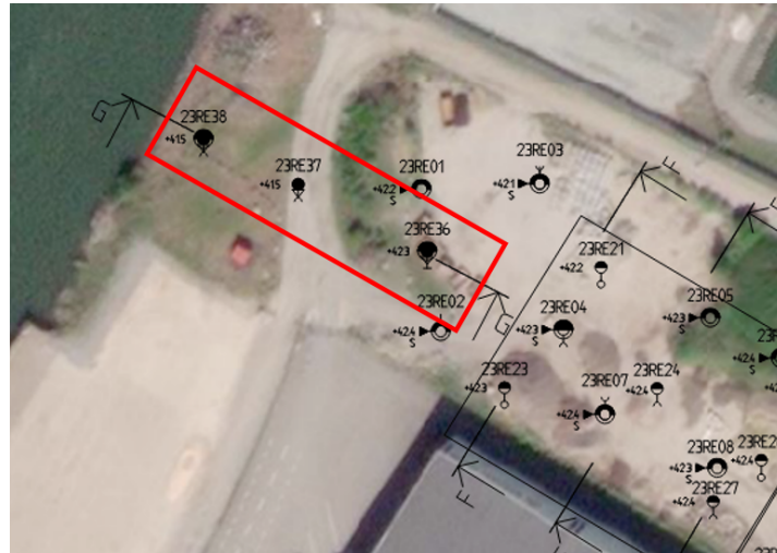
Figur 5.7a Undersökningspunkterna som har utförts för att kunna etablera en beräkningssektion för tillbyggnaden norr om befintlig byggnad visas med röd markering.
